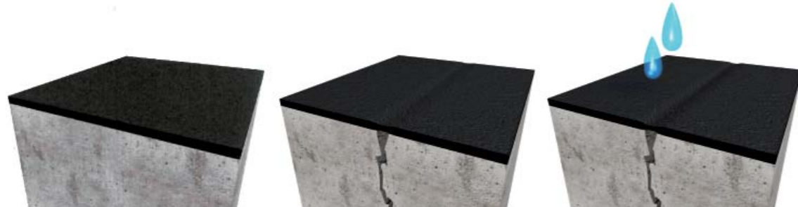
2. Halkeamat sillastava vedeneristys: Tässä tapauksessa elastisuuden ja kerrospaksuuden ansiosta. Vedeneristyskerros kestä jatkuvaa vedenpainetta.
