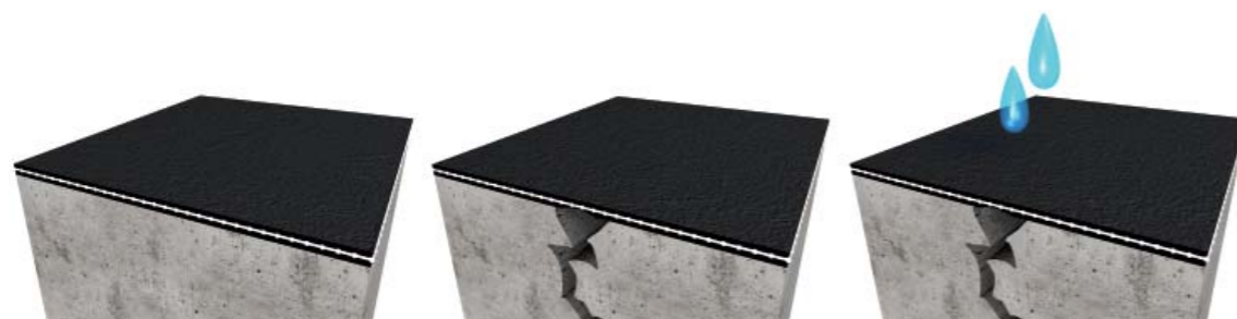
3. Halkeaman sillastus upotetun verkon ansiosta. Verkko erottaa ylemmän vedeneristyskerroksen halkeamasta ja auttaa merkittävästi kestäämään jatkuvaa vedenpainetta.
