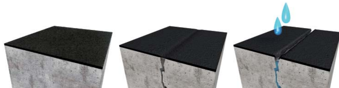
1. Elastinen mutta ei halkeamat sillastava: Vedeneristyskerros ei kestä jatkuvaa vedenpainetta.
